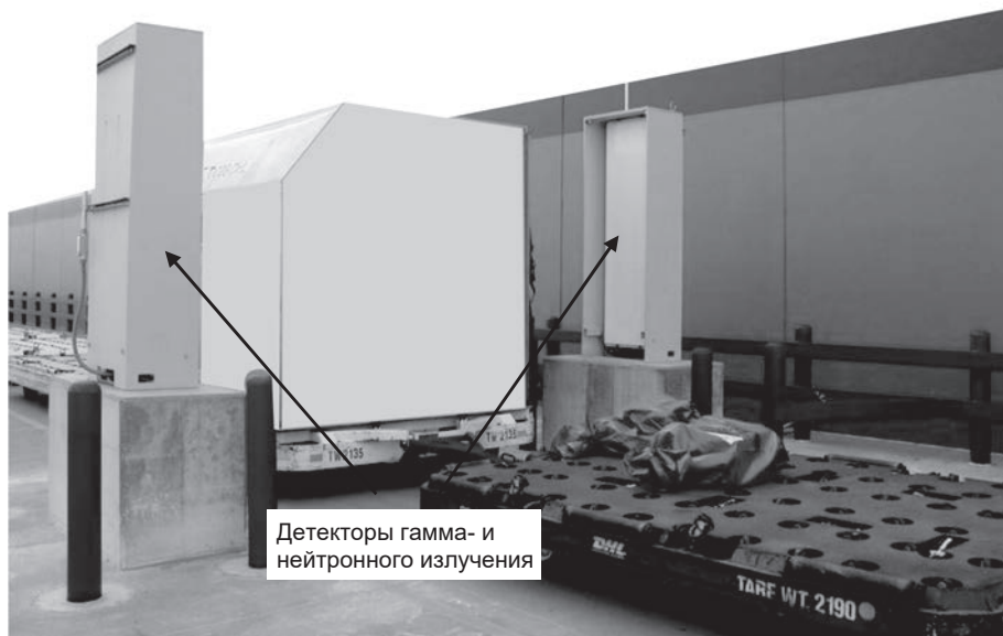
Рис. 2. РПМ используется для контроля почтового контейнера, предназначенного для перевозки воздушным транспортом.
