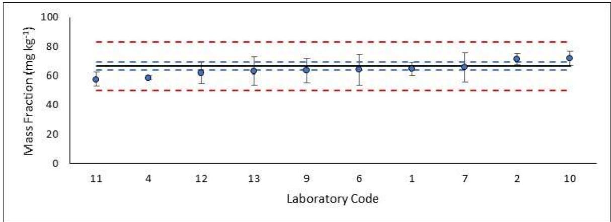
—  $X_{\text{ass}}$ ;  $\bullet \bar{X}_{\text{lab}} \pm U_{\text{lab}}$ ; - - -  $X_{\text{ass}} \pm 2\sigma_p$ ; - · -  $X_{\text{ass}} \pm U_{\text{ass}}(k=2)$
