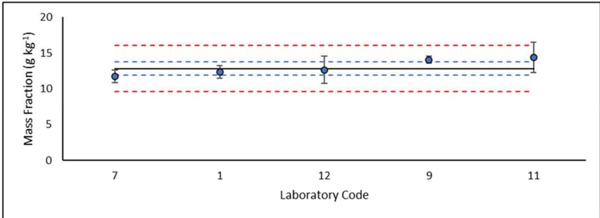
—  $X_{\text{ass}}$  ;  $\bullet X_{\text{lab}} \pm U_{\text{lab}}$  ; - - -  $X_{\text{ass}} \pm 2\sigma_p$  ; - - -  $X_{\text{ass}} \pm U_{\text{ass}}(k=2)$
