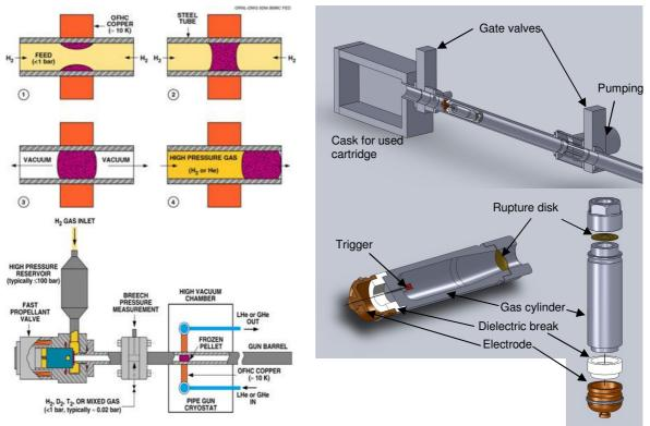
Figure 10 Pipe gun injector for MPI DMS
