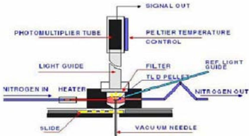
*Fig. 2. TLD main components.*
