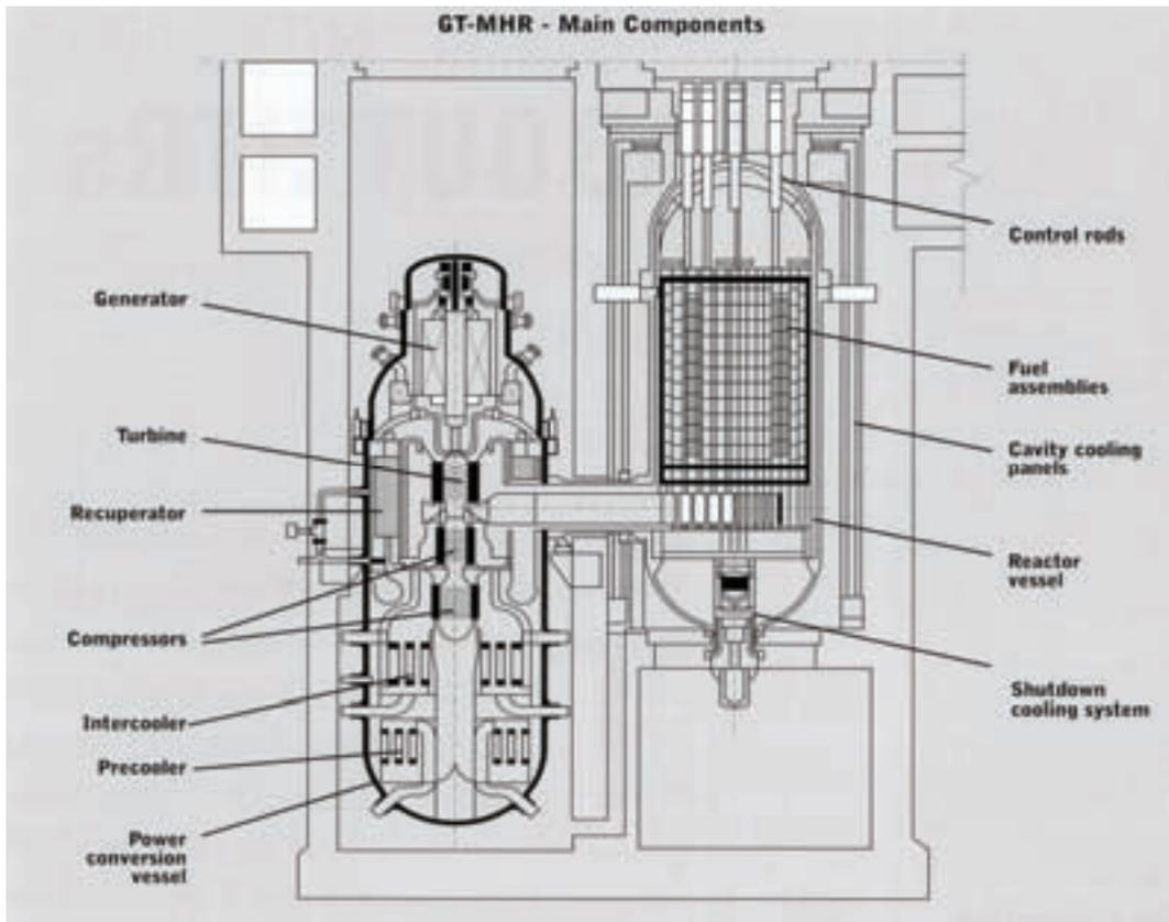
Figure 7. GT-MHR module arrangement.
