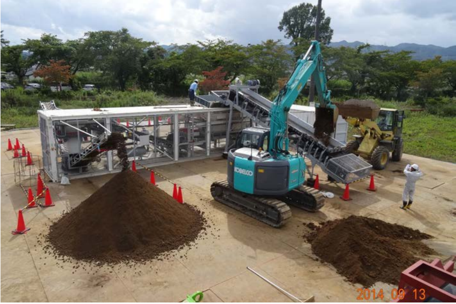
الشكل-27- وحدة فرز التربة الملوثة المستخدمة في محطة فوكوشيما دايتشي للقوى النووية. بإذن من شركة GRS VALTECH.
