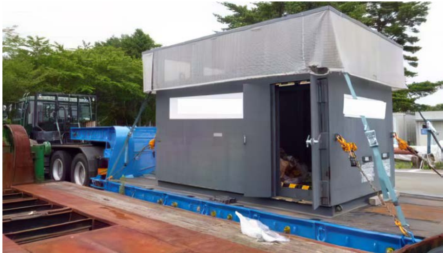
الشكل-30- نظام متنقل لمعالجة المياه الملوثة في الخندق الرئيسي في فوكوشيما. بإذن من شركة طوكيو القابضة للطاقة الكهربائية.
