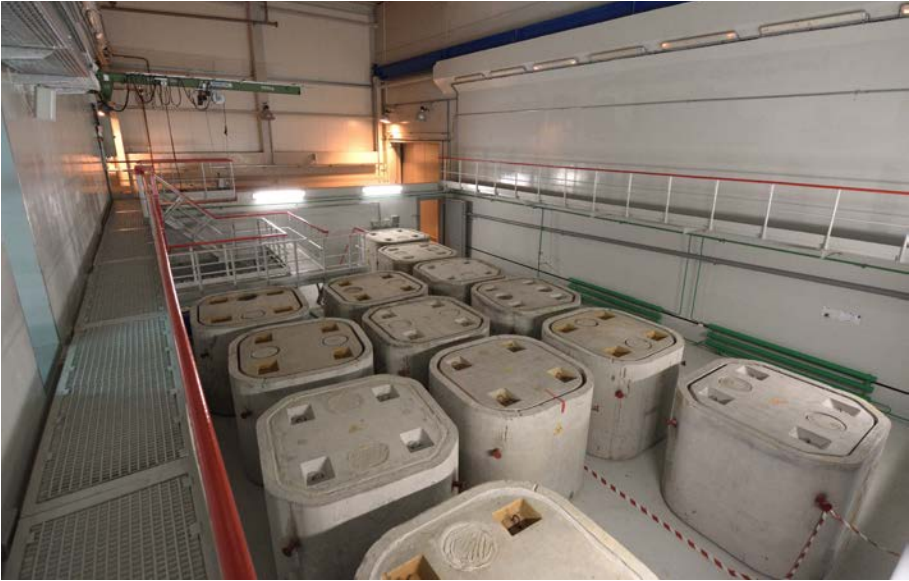
الشكل-50- مرفق خزن مؤقت للنفايات الصلبة في المجمع الصناعي للتصرف في النفايات المشعة الصلبة تظهر فيه حاويات من النوع KZ-3 لخرن النفايات الصلبة الضعيفة والمتوسطة الإشعاع القصيرة العمر المعالجتها. بإذن من المؤسسة الحكومية المتخصصة "محطة تشرنوبل للقوى النووية".
