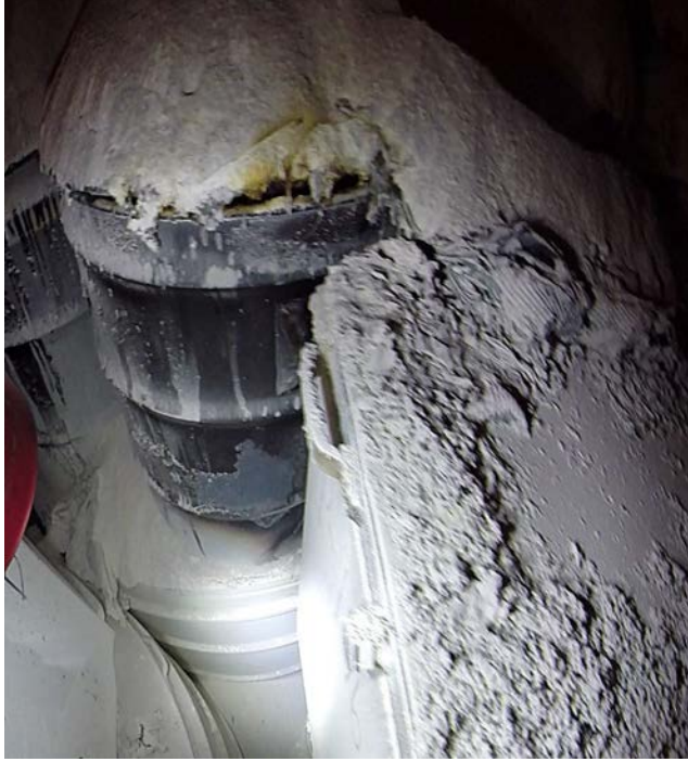
الشكل-44- برمبل مشقوق في المقصورة رقم 7، الغرفة 7، من المستودع الجيولوجي في المحطة التجريبية لعزل النفايات. بإذن من وزارة الطاقة في الولايات المتحدة [164]
