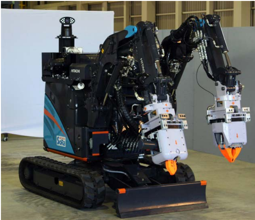
الشكل-21- روبوت التحكم عن بُعد (ASTACO-SoRa) يُستخدم لإزالة الركام والحطام في مباني المفاعل، مما يُقلل بشكل كبير من الجرعة التي يتلقاها العمال. بإذن من شركة طوكيو القابضة للطاقة الكهربائية.
