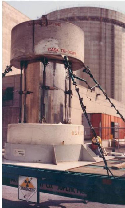
الشكل-43- تجهيز البرميل CNS 1-13C للشحن في تري مايل آيلند. بإذن من مختبر أيداهو الوطني والهيئة الرقابية النووية في الولايات المتحدة [152].
