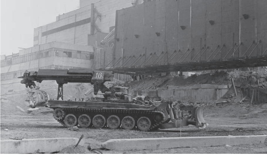
الشكل-14- استُخدمت المركبة الهندسية العسكرية المدرّعة من طراز IMR-2 التي تعود إلى الحقبة السوفياتية على نطاق واسع بعد الحادث لإجراء أعمال الاستطلاع الإشعاعي والتفكيك وإزالة الحطام وجمع النفايات وغير ذلك من الأنشطة ذات الصلة بالتنظيف. بإذن من متحف تشرنوبل الوطني الأوكراني.
