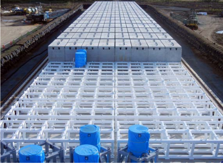
الشكل-48- مثال يوضح خزن أبراج امتزاز السيزيوم في فوكوشيما. بإذن من شركة طوكيو القابضة للطاقة الكهربائية
