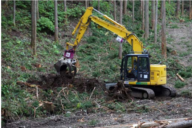
الشكل-19- آلات بناء غير مأهولة يتم التحكم فيها عن بُعد لإزالة النباتات في المناطق خارج الموقع في منطقة فوكوشيما. بإذن من شركة كاجيما.
