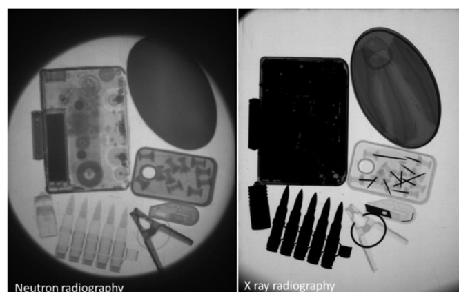
Fig. 21. Comparación de imágenes obtenidas con radiografía neutrónica (izquierda) y de rayos X (derecha). La radiografía neutrónica puede utilizarse para investigar objetos con materiales que contienen hidrógeno. Cortesía de la Universidad de Kindai (Osaka, Japón).
