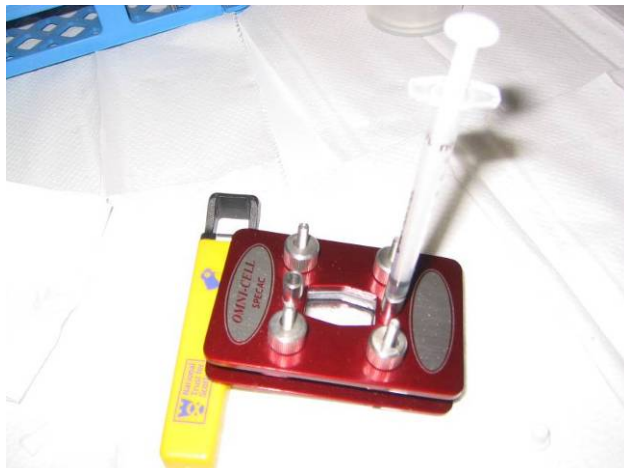
Fig. 24. Cubeta de espectrometría FTIR con una jeringa de 1 ml en el orificio de llenado. Levantar la cubeta por uno de los costados apoyándola en cualquier objeto conveniente, por ejemplo un lápiz.
