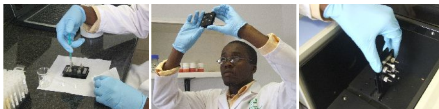
Fig. 25. Procedimiento de carga de la cubeta. Tras llenarla con una jeringa de 1 ml y observarla a contraluz para comprobar que no contenga burbujas, se coloca la cubeta en el compartimento de muestras del espectrómetro FTIR.
