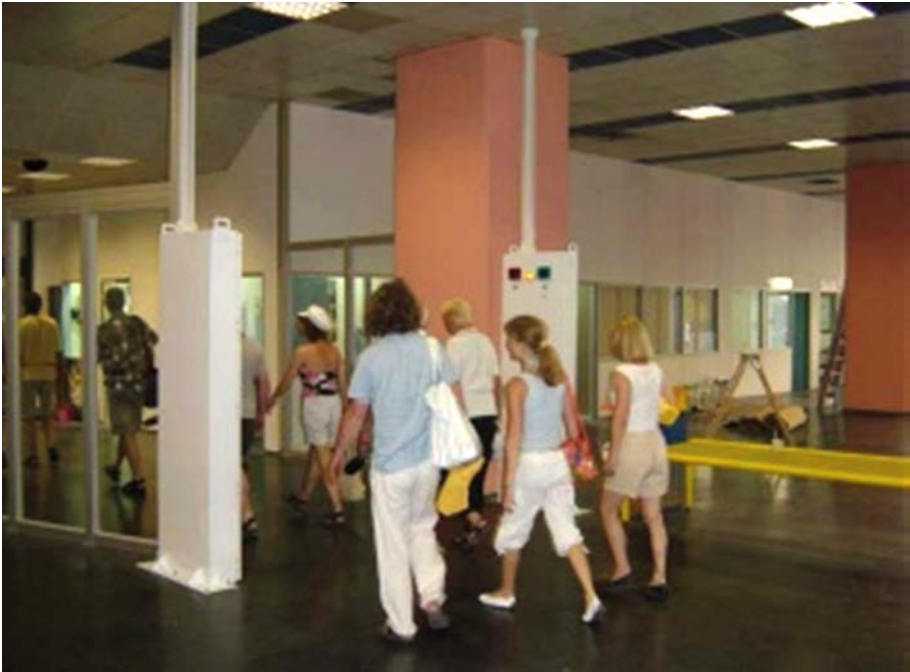
Fig. V-4. Ejemplo típico de un pórtico detector de radiación para peatones instalado en un puerto.
