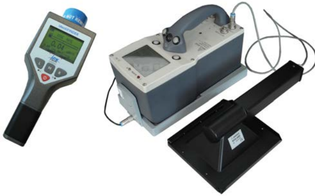
Fig. V-7. Dispositivos de mano típicos para la identificación de radionucleidos.
