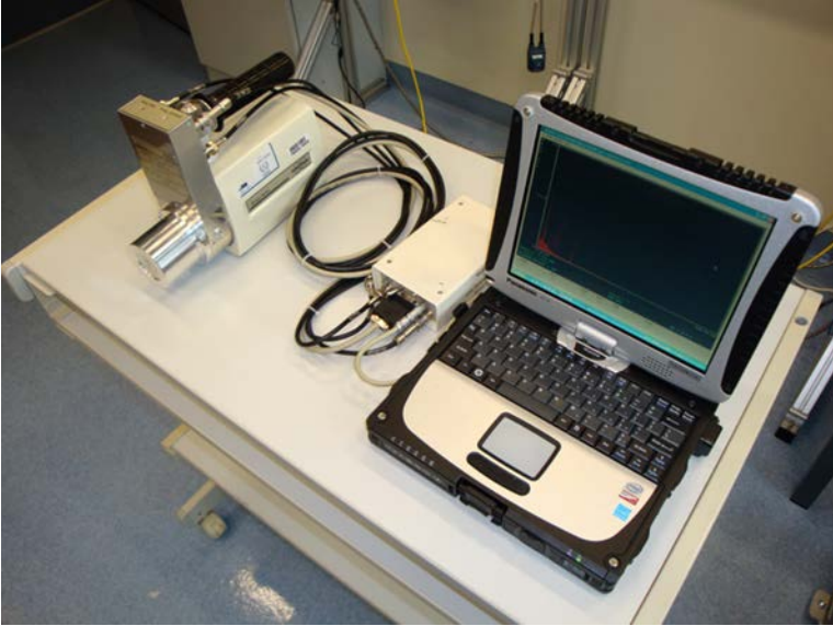
Fig. V-9. Ejemplo de un sistema típico de espectrometría gamma de alta resolución con un detector de Ge(HP) refrigerado por nitrógeno líquido.
