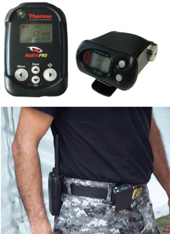
Fig. V-1. Ejemplo típico de un detector de radiación personal.
