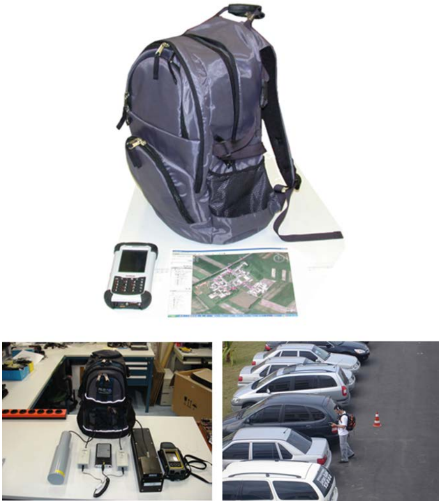
Fig. V-2. Representación de un escáner de radiación portátil, con un modo de reconocimiento.
