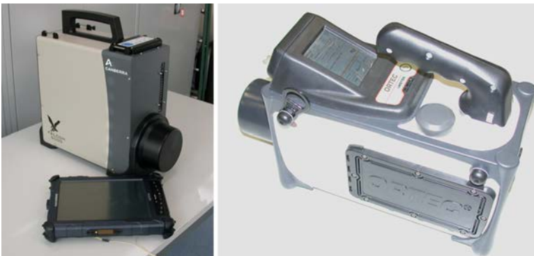
Fig. V-8. Ejemplos de sistemas típicos de espectrometría gamma de alta resolución con un detector de Ge(HP) de refrigeración eléctrica.
