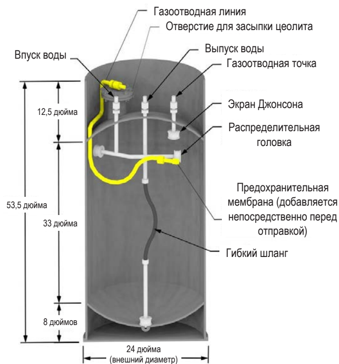
РИС. 35. Поперечный разрез резервуара SDS на TMA-2. Взято с изменениями из [2].
