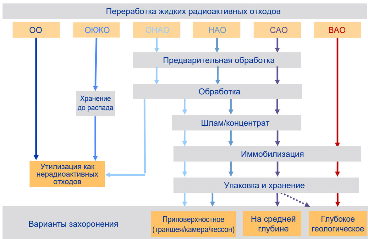
РИС. 25. Схема процесса обращения с жидкими радиоактивными отходами. Взято с изменениями из [125].
