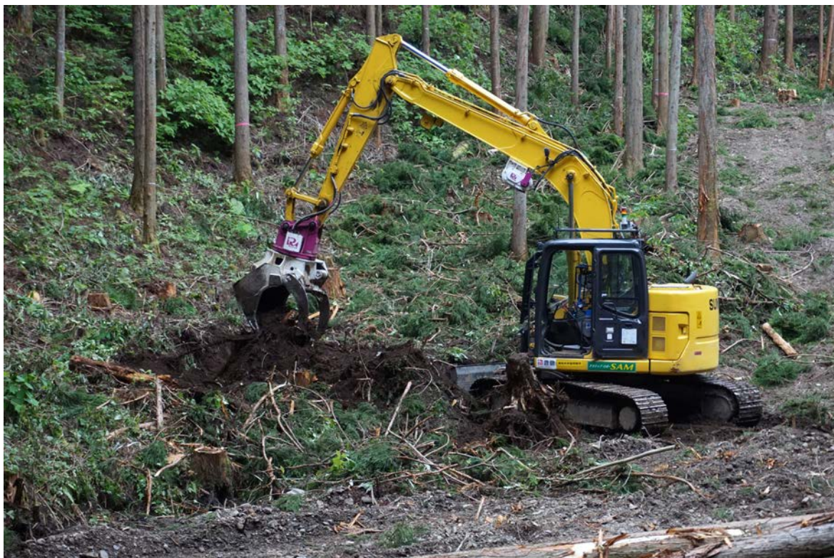
РИС. 19. Беспилотные строительные машины с дистанционным управлением, использовавшиеся для расчистки растительности за пределами площадки в префектуре Фукусима. Публикуется с разрешения «Кадзима корпорейшин».
