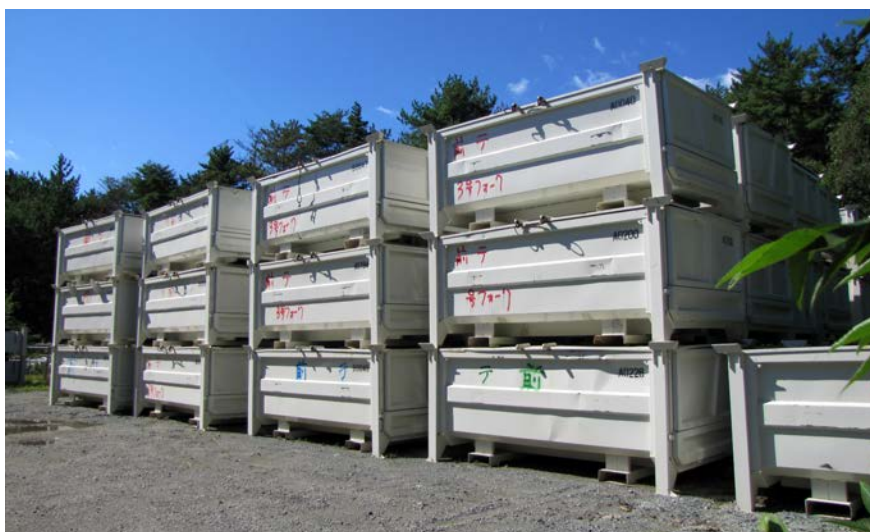
РИС. 37. АЭС «Фукусима-дайти»: контейнеры для временного хранения отходов. Публикуется с разрешения Токийской электроэнергетической компании.
