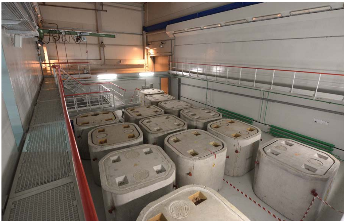
РИС. 50. Временное хранилище твердых отходов в промышленном комплексе по обращению с твердыми радиоактивными отходами (ПКОТРО); показаны контейнеры типа КЗ-3 для хранения переработанных твердых короткоживущих отходов низкого и среднего уровня активности. Публикуется с разрешения Государственного специализированного предприятия «Чернобыльская АЭС».
