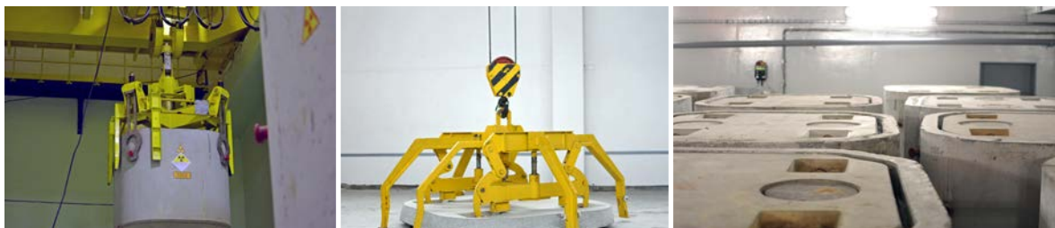
РИС. 40. Бетонный контейнер КЗ-3.0, используемый на Чернобыльской АЭС: конфигурация для подъема и перемещения (слева); крышка для перевозки (в середине); хранение (справа). Публикуется с разрешения Государственного специализированного предприятия «Чернобыльская АЭС».
