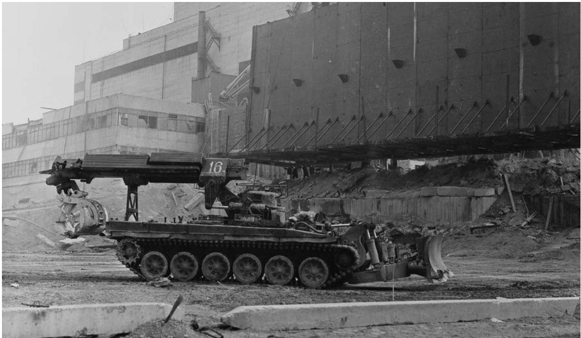
РИС. 14. Военная гусеничная инженерная машина разграждения ИМР-2 советского производства, широко использовавшаяся после аварии для радиологической разведки, демонтажа, разбора завалов, сбора отходов и других работ, связанных с очисткой. Публикуется с разрешения Украинского национального музея «Чернобыль».
