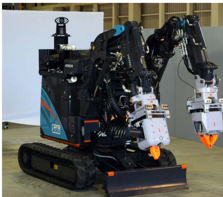
РИС. 21. Робот с дистанционным управлением (ASTACO-SoRa), использовавшийся для разбора завалов и обломков в реакторных зданиях, что позволило значительно снизить дозу облучения рабочих. Публикуется с разрешения Токийской электроэнергетической компании.
