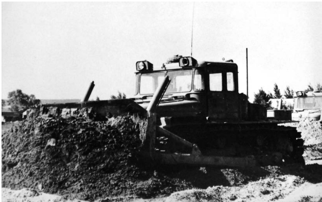
РИС. 17. Дистанционно управляемая машина для землеройных работ с герметичной кабиной, использовавшаяся на Чернобыльской АЭС. Публикуется с разрешения Украинского общества дружбы и культурных связей с зарубежными странами.
