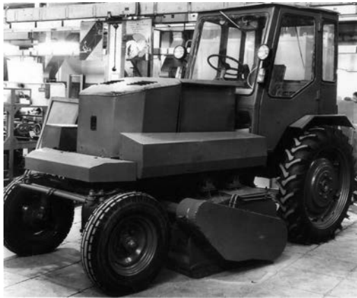
РИС. 16. Модифицированные тракторы, использовавшиеся при ликвидации последствий аварии на Чернобыльской АЭС. а) Трактор МТЗ-80, использовавшийся при очистке улиц для сбора радиоактивной пыли и мусора. б) Модифицированный трактор «Челябинск» с мощным экранированием, использовавшийся для очистки территорий, примыкающих к поврежденному реактору энергоблока № 4, и для перевозки грузов. Публикуется с разрешения Украинского национального музея «Чернобыль».
