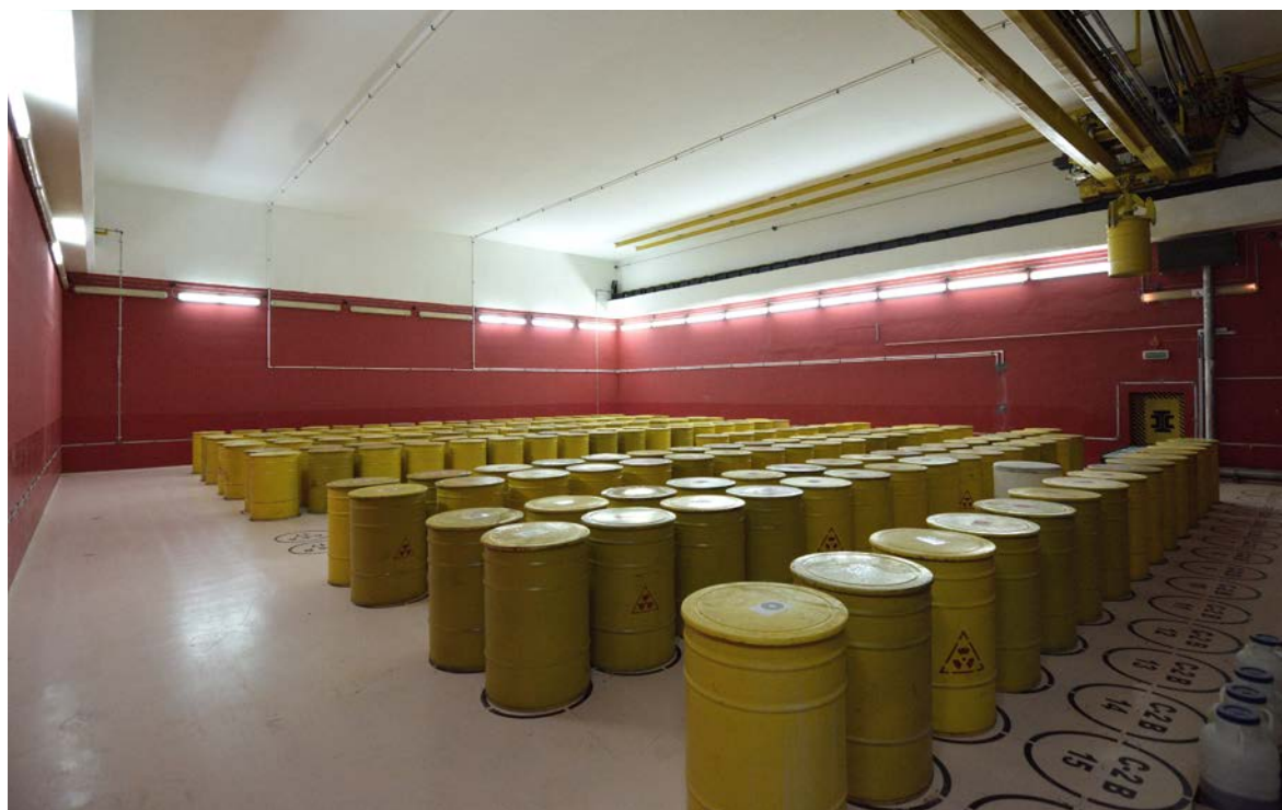
РИС. 49. Зал для хранения обработанных жидких отходов на Чернобыльском заводе по переработке жидких радиоактивных отходов. Публикуется с разрешения Государственного специализированного предприятия «Чернобыльская АЭС».
