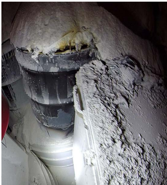
РИС. 44. Разорвавшийся контейнер в секции 7, камере 7 геологического хранилища WIPP. Публикуется с разрешения Министерства энергетики США [164].
