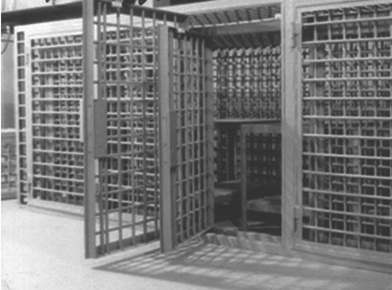
FIG. 35. Double cage en acier pour l'entreposage de matières nucléaires (reproduit avec l'aimable autorisation des Laboratoires nationaux Sandia)
