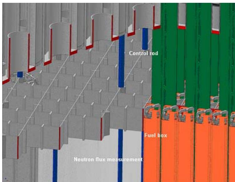
*Fig. 3. Control Rods*
