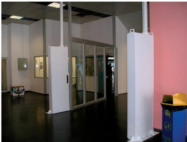
*Рис. 17. Типичный пешеходный монитор, установленный в аэропорту.*
