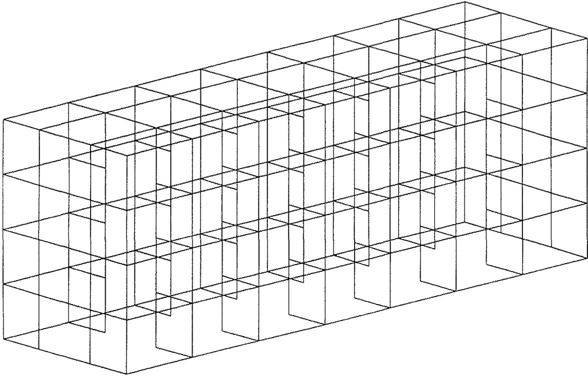
Fig. 5 3D FINITE ELEMENT MODEL OF CONTROL PANELS FOR KANUPP
