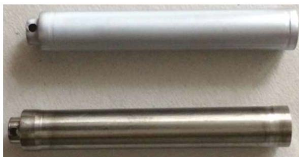
图 127. Cr 涂层 (上) 和 Zr 参考试样 (下)。
