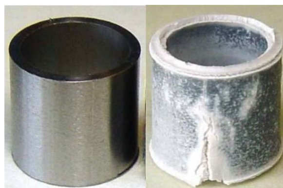
图 132. Zr 样品在 1200°C 空气中氧化前 (左) 和氧化 2700 s 之后 (右)，归一化质量增加为 \Delta m/A=491 \text{ g/m}^2 。
