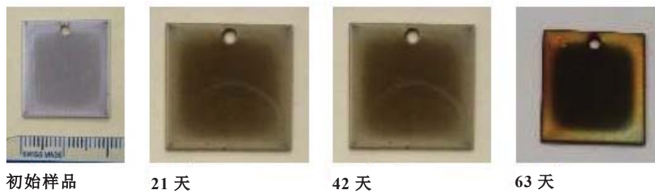
图 54. 腐蚀前后 Cr 涂层 Zry-2 样品的表面形貌。
