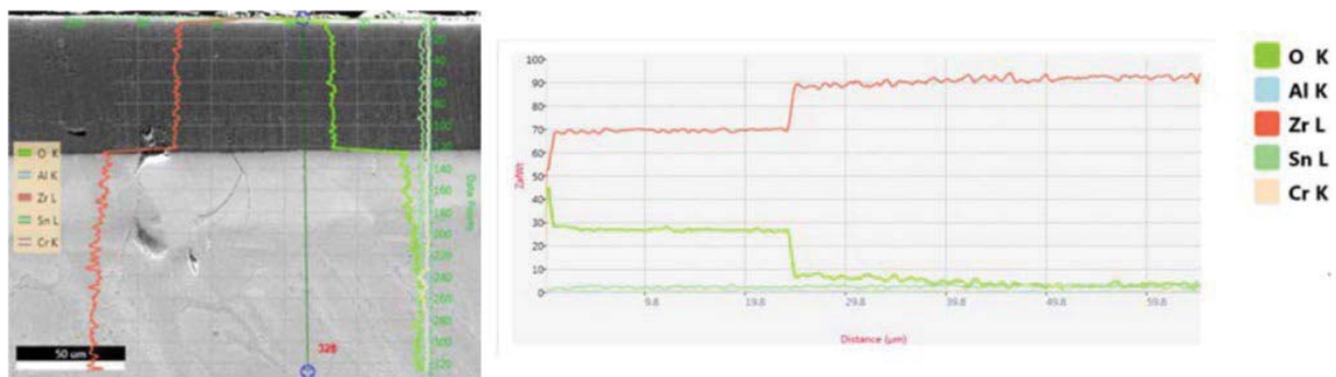
图 98. SPP5 样品经过 1200°C 处理 30 分钟后其中的氧化物层和 \alpha -Zr 层的 SEM-EDS 线扫描谱图。
