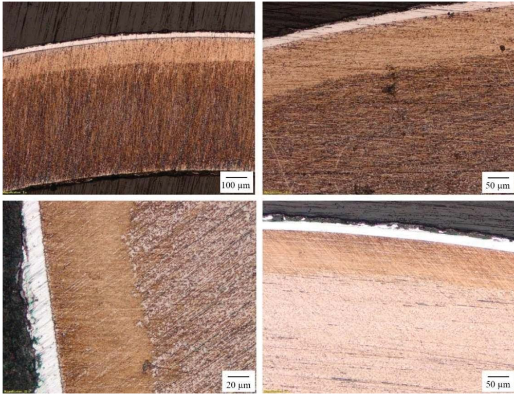
图 144. 样品 IAEA-06 (CrPVD 涂层 Zr1Nb) 的金相图像。
