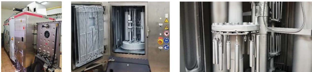
图 2. CTU 的 Hauzer Flexicoat 850 图片。其中: 系统概览 (左); 沉积室 (中); 旋转的样品架及后面的 Cr 靶 (右) Elsevier[182])。
