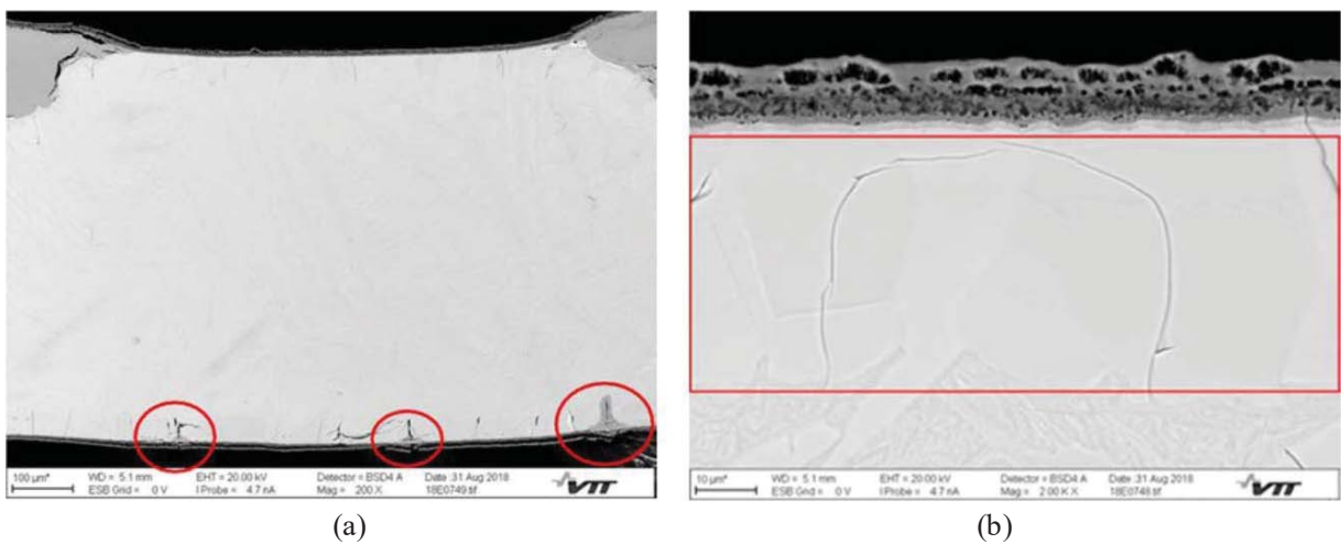
图 101. 经过 1300°C 处理 5 分钟后的 SPP6 样品: (a) 来自 SPP6 样品中间区域的完整横截面, (b) 来自 (a) 图中上部区域的细节。
