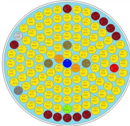
FIG. 4. TRIGA RC-1 core.
