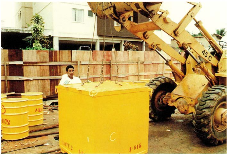
20. Uno de los contenedores metálicos de almacenamiento construidos especialmente para contener 5 toneladas de desechos.
