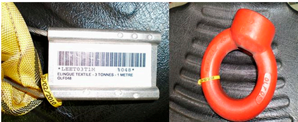
FIG. 35. Tool expiry date labelling (courtesy of Électricité de France).
