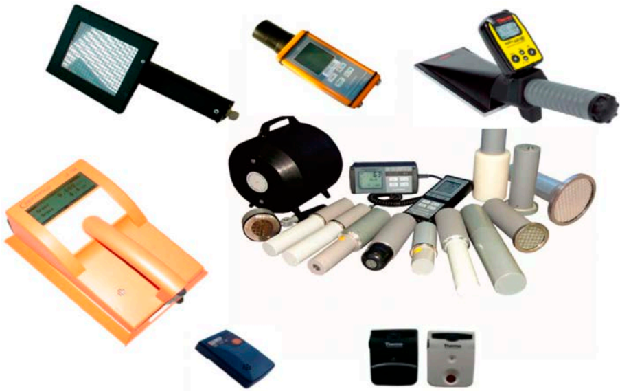
Fig. I-1. Diferentes modelos y tipos de instrumentos de mano que pueden servir para evaluar los peligros radiológicos in situ.
