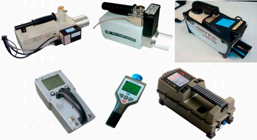
Fig. I-2. Diferentes modelos y tipos de instrumentos que pueden servir para identificar los materiales radiactivos in situ.
