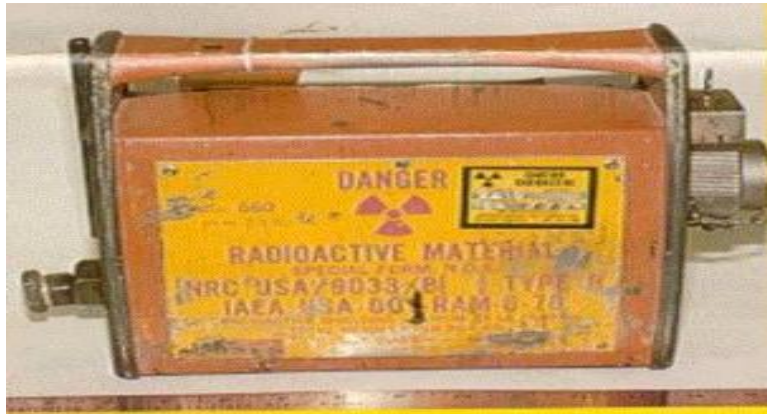
FIG. 7. Caméra de radiographie typique.
