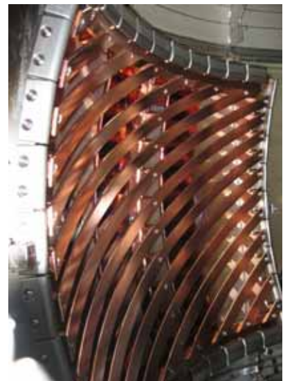
FIG. 1. TST-2 HHFW Antenna.
